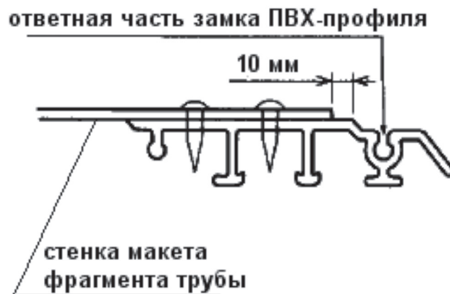
Рисунок 6 – Фиксация кольца из ПВХ-профиля в макете фрагмента трубы
