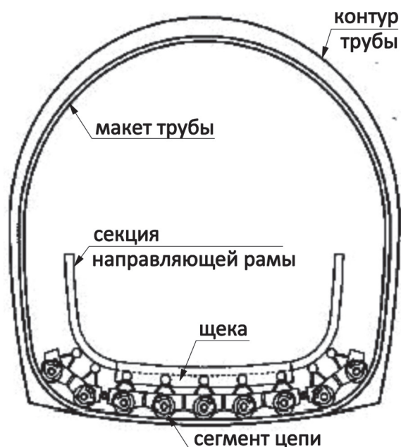
Рисунок 7 – Первый этап сборки навивочной машины
